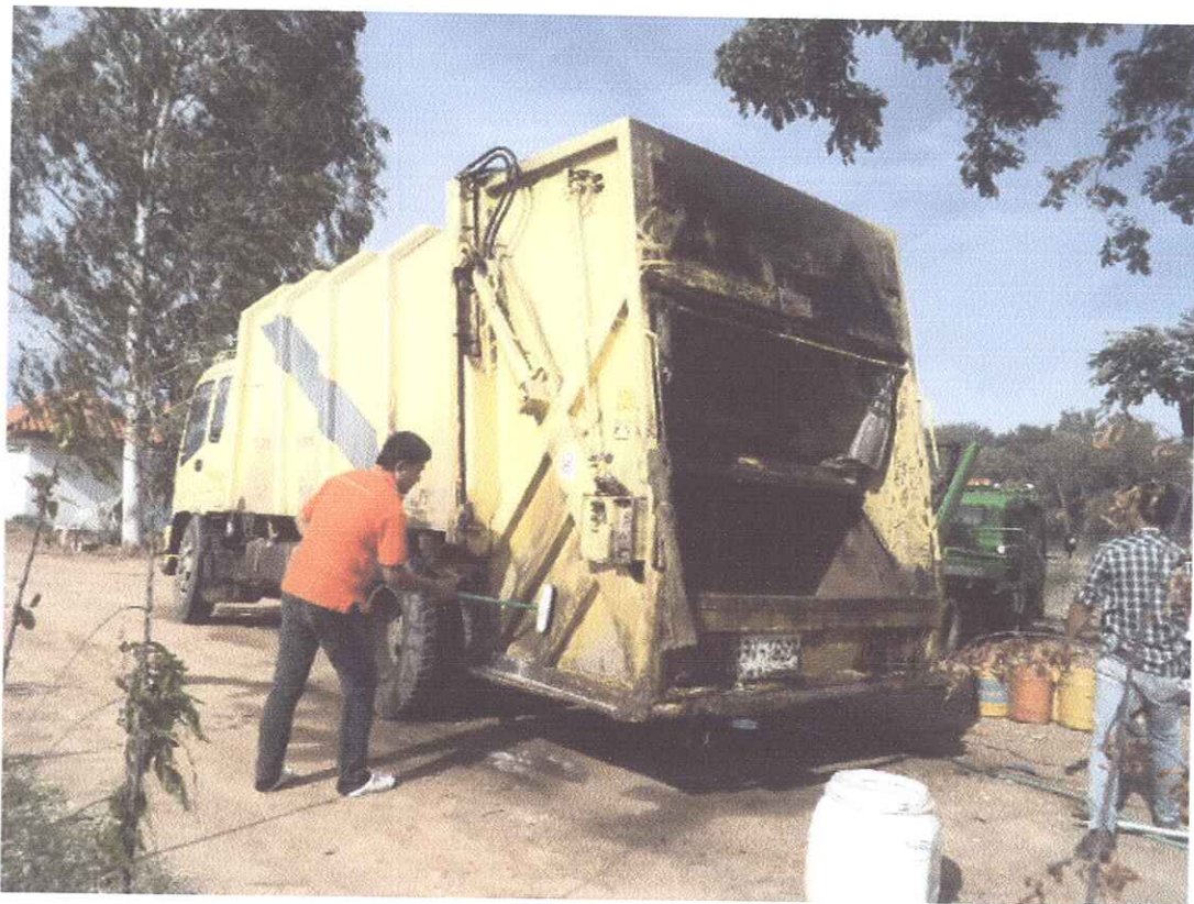
รูปที่ 6 ล้างทำความสะอาดรถหลังเก็บขนขยะเป็นประจำทุกวัน
